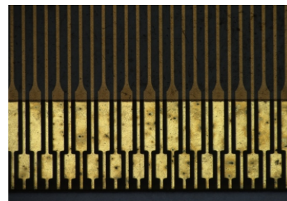
外置同轴光源-液晶屏顶部接线
